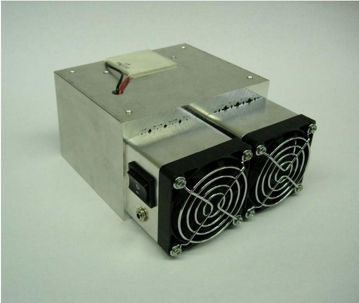
Das Peltier-Explorer-Kit ist ein fertig aufgebauter Demonstrator zur Peltiertechnik. Mit ihm kann der Peltiereffekt sowie die Leistungsfähigkeit eines Peltierelementes demonstriert werden. Die massive Ausführung ermöglicht eigene Versuchsaufbauten. Darüber hinaus können Versuche zum Seebeck-Effekt (Thermogenerator) und mit Heatpipes durchgeführt werden.
